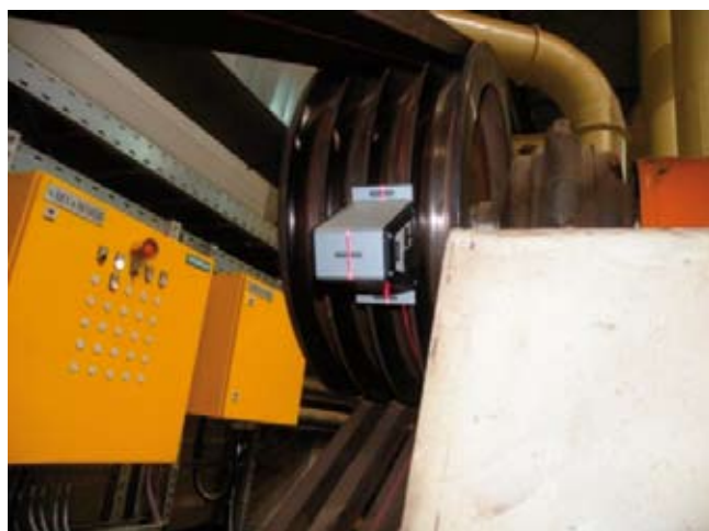
Слика 4.96. Примена опреме за ласерско поравнавање каишних преносника - BELT ALIGNMENT TOOL TMEB2
