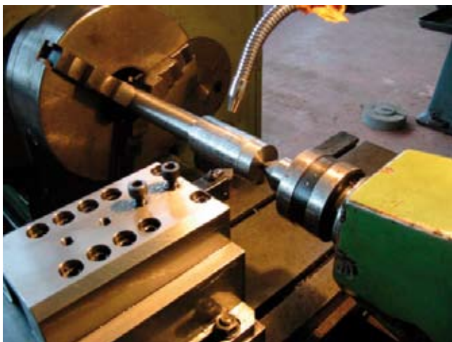
Пиезоелектрични динамометар за мерење отпора резања KISTLER
