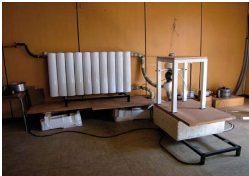
Слика 4.105. Инсталација за испитивање термичких перформанси грејних тела
