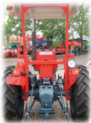
Слика 4.99. Рам-оквир са качкетом (ROLL BAR) ЗА ТРАКТОРЕ IMT 533, 539, 558
