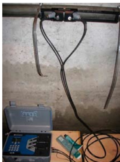
Слика 4.71. Мерење протока воде ултразвучним мерачем протока
