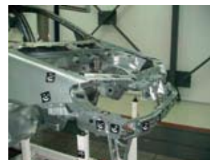
Контрола квалитета каросерије аутомобила Фиат Пунто коришћењем система TRITOP
