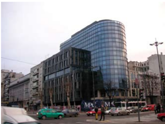
Слика 4.161. Композитни панели типа „АЛУКОВОНД“ и ламинирано стакло примењени у грађевинарству
