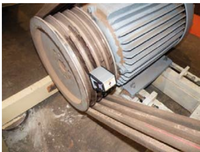
Слика 4.96. Примена опреме за ласерско поравнавање каишних преносника - BELT ALIGNMENT TOOL TMEB2
