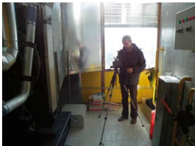
Слика 4.94. Примена опреме за испитивање параметара буке и њеног утицаја на радну средину - ADVANCED SOUND LEVEL METER ANALYZER 2250
