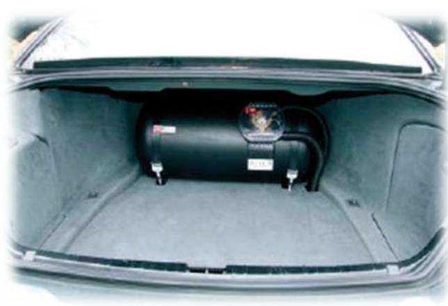
Слика 4.102. Преправка возила, уградња уређаја и опреме за погон возила на TNG
