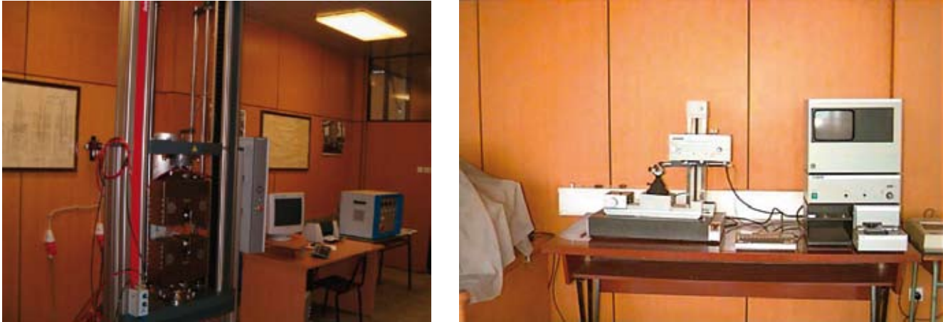
Слика 4.26. Мали део савремене опреме: Компјутеризована машина за испитивање карактеристика материјала типа ZWICK/ROELL Z 100 (произведена 2003.) и савремени систем мерења храпавости (TAYLOR-HOBSON)
