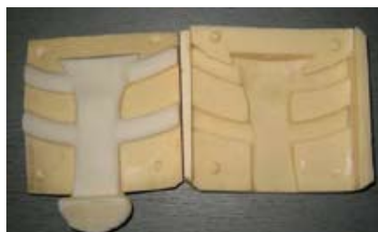
Слика 4.134. Од виртуелног модела преко RP модела до импланта грудне кости
