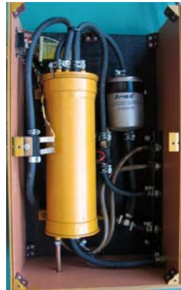
Слика 4.61. ЛАБОРАТОРИЈСКИ УРЕЂАЈ ЗА НАПАЈАЊЕ МОТОРА ГОРИВОМ
