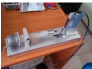
Слика 4.152. Једноосни „STRETCH“ СИСТЕМ ЗА ИСПИТИВАЊЕ МЕХАНИЧКИХ КАРАКТЕРИСТИКА БИОЛОШКИХ ТКИВА
