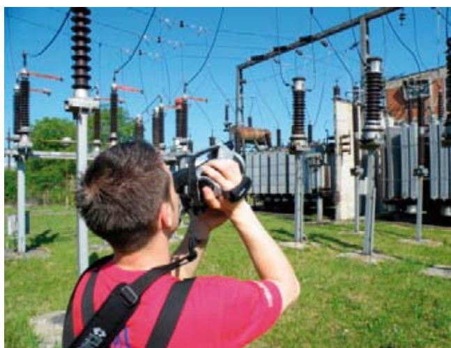
Слика 4.95. Примена опреме за термовизијска испитивања - THERMAM P640
