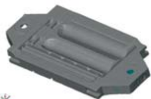
* Дигитализација површине алата за израду црепа коришћењем система ATOS
