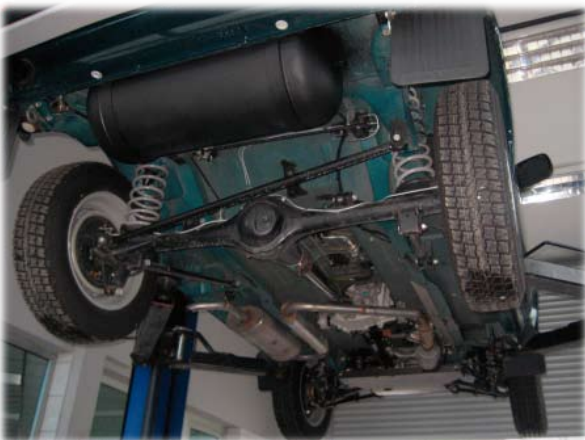
Слика 4.102. Преправка возила, уградња уређаја и опреме за погон возила на TNG
