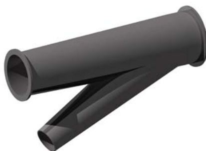
Слика 5. 3Д модел тројника упрошћене конструкције
