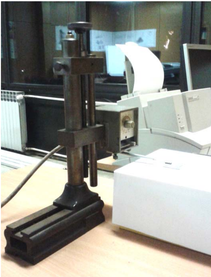
Слика 4.17 Мерни уређај Tester-P1 фирме Hommel Werke са мерном иглом
