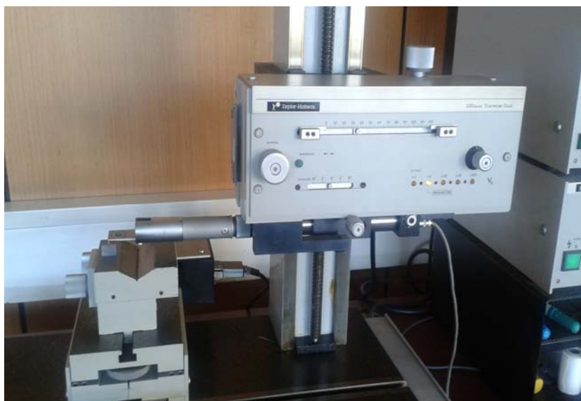
Слика 4.3. Мерни систем за Talysurf-6 повезан са рачунаром и пример мерења
