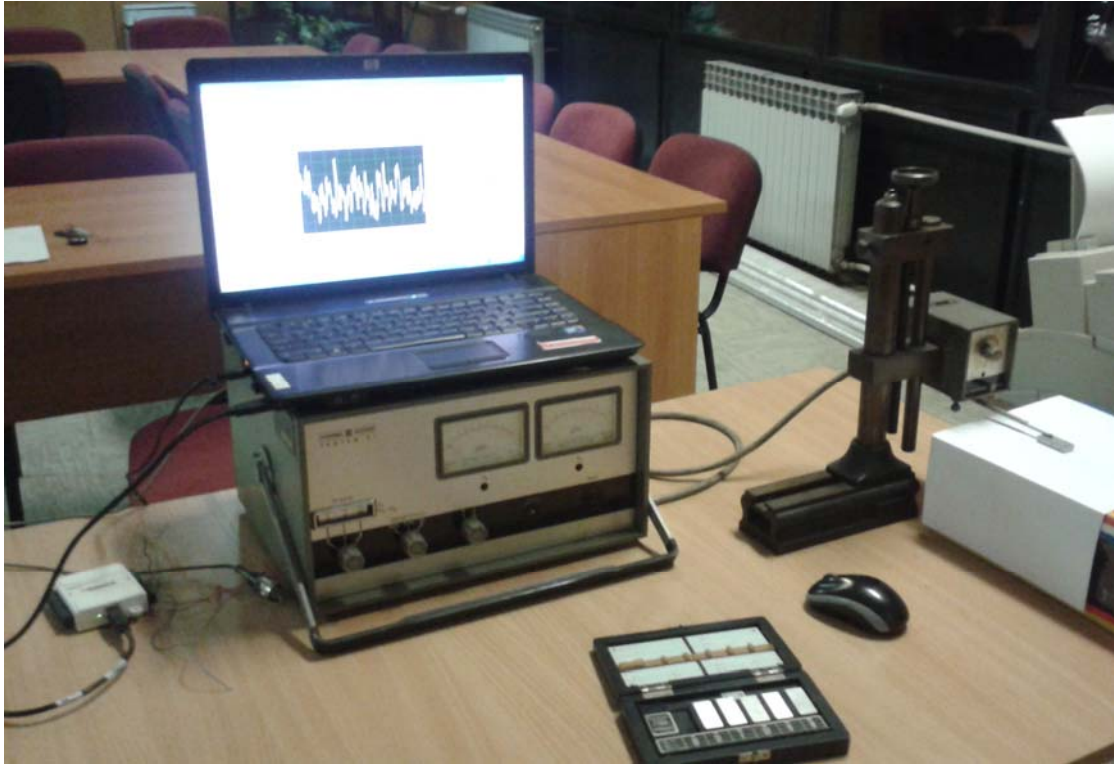
Слика 4.16. Мерни уређај Tester-P1 повезан са рачунаром помоћу АД конвертора
