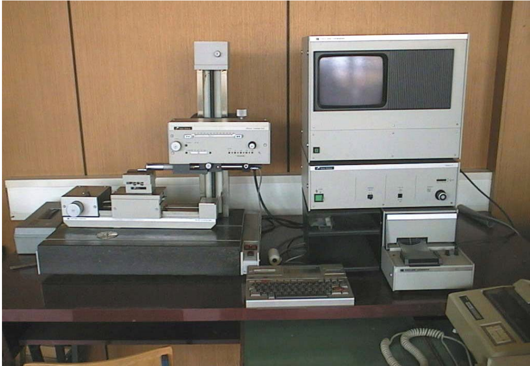
Слика 4.1. Уређај за мерење хрпавости Talysurf 6
