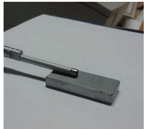
Слика 4.17 Мерни уређај Tester-P1 фирме Hommel Werke са мерном иглом
